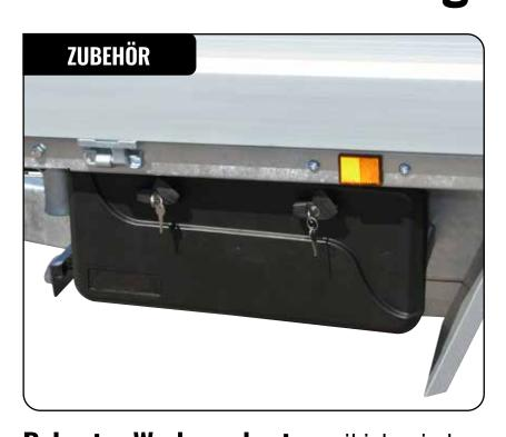
**Robuster Werkzeugkasten** mit integriertem Schloß für die Aufbewahrung von z.B. Verzurrgurten etc.
